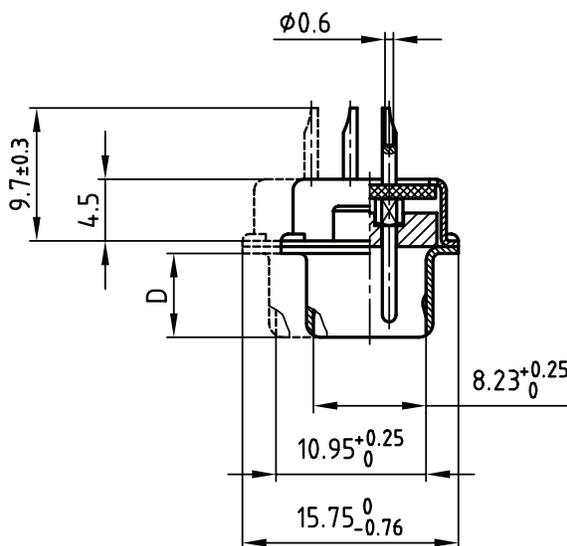
Lötkelch geeignet für Kabel AWG 26
